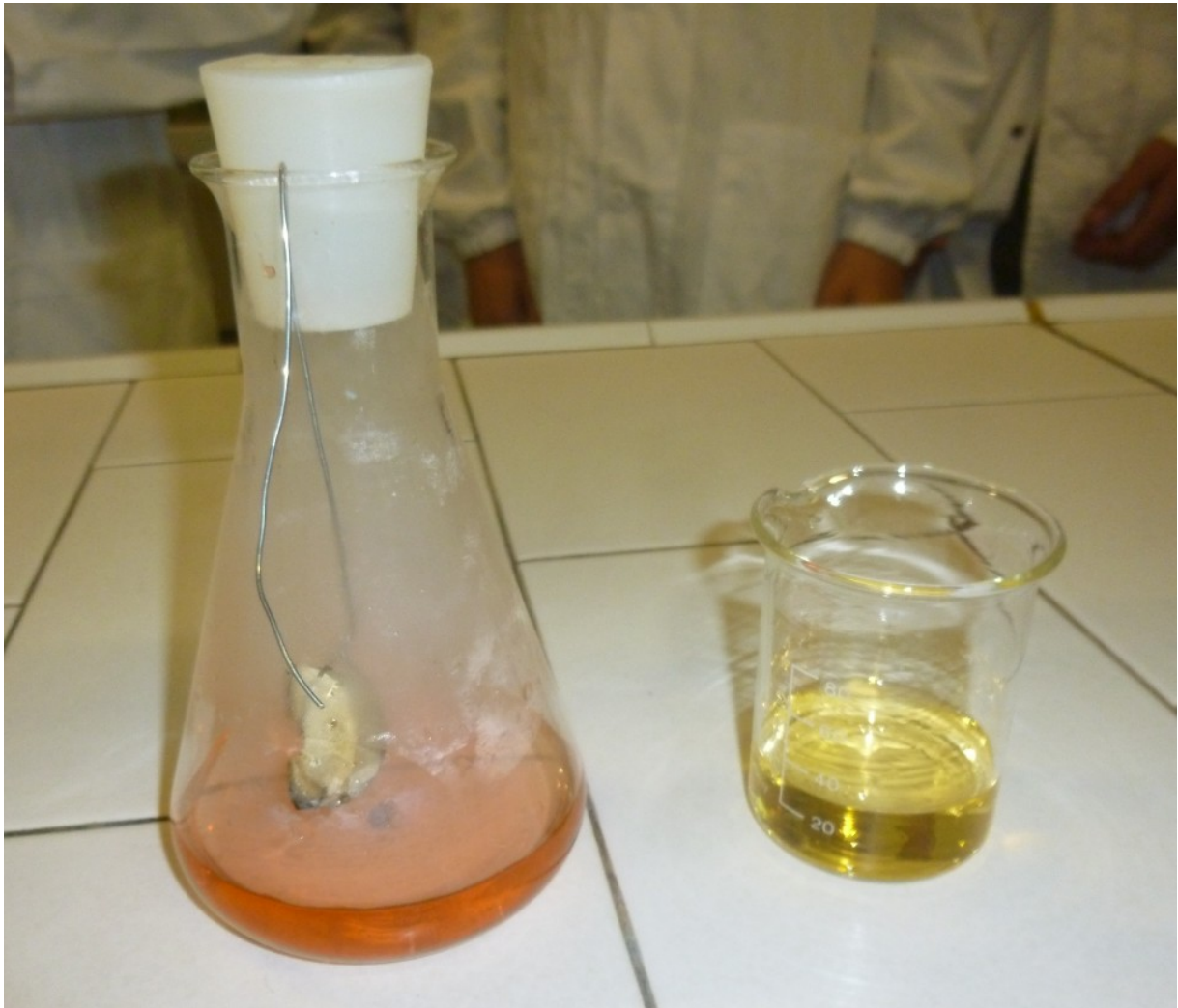
colorazione della soluzione \text{H}_2\text{O} + \text{SO}_2 con metilarancio
